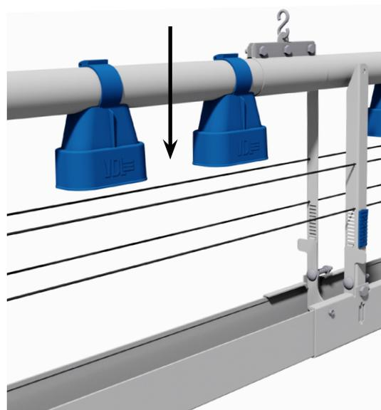
Во время кормления лоток опускается с помощью лебедочной системы в *положение для кормления*, чтобы все петухи одновременно получили корм.
