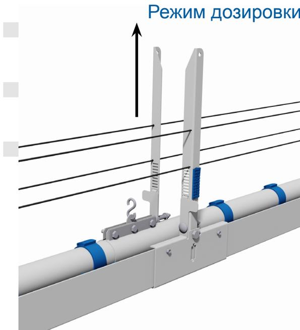
В *режиме дозирования* труба транспортировки корма находится в одном из *восьми возможных положений* по высоте и таким образом дозируются порции корма.
